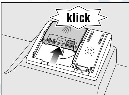
Ячейка с моющим средством открывается автоматически в зависимости от выбранной программы в самый подходящий для этого момента времени. Порошкообразное или жидкое моющее средство распределяется внутри машины и затем растворяется. Таблетка моющего средства падает в машину и там растворяется.
